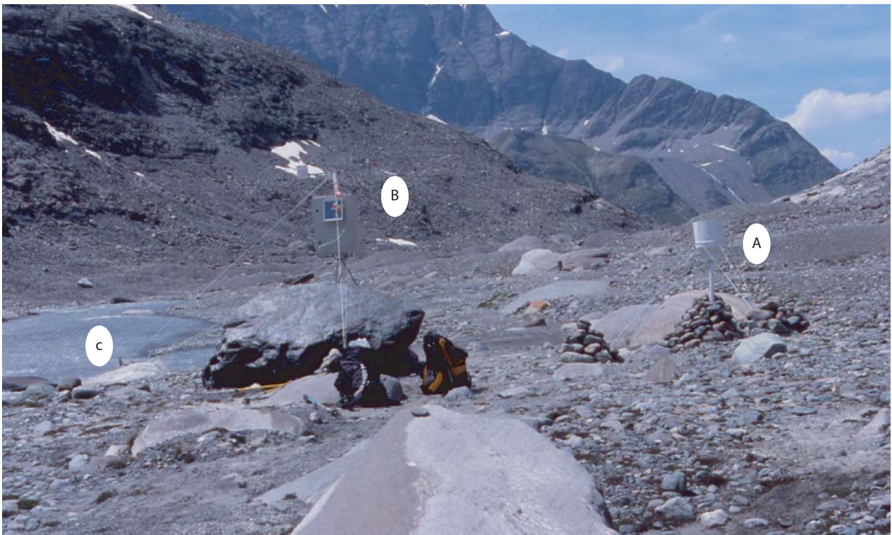
Ph. 2.4 : La station de mesure hydrométéorologique a : pluviomètre; b : station d'acquisition et capteurs atmosphériques; c : limnigraphe (Photo : S. Jobard)
