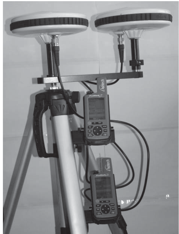
Photo 2.11: le DGPS Ashtech configuré pour une phase d'initialisation.
